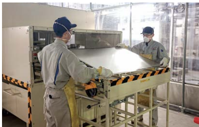
■ パネルセパレータ処理後のCIS薄膜太陽電池モジュール
